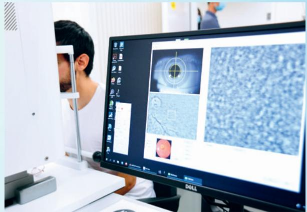
Un dispositif innovant d'imagerie d'optique adaptative, développé à l'EPFL par Earlysight, permet de capturer de manière unique des images des cellules se trouvant derrière les photorécepteurs.
